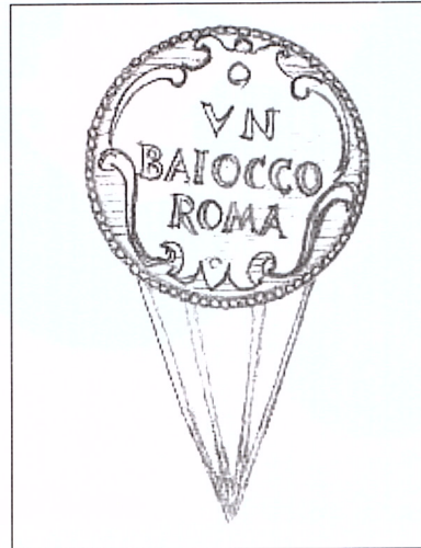
2. pegar hilos de cera (0,8 mm) sobre la parte superior del modelo, como en el diseño ....
