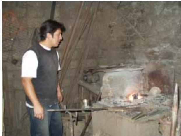
específico en el proceso. Entre las partes que conforman la fragua tenemos: el hogar, que es el espacio donde se produce la combustión y el hierro es calentado; la tobera, que es el conducto que lleva el aire hacia el hogar y la chimenea, compuesta por la campana y el cañón y que es por donde se expulsa el humo.
