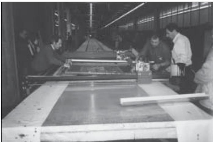
diferentes cuadros fueran paralelos o casi, como en el estampado de fondos o haciendo referencia a zonas bastante amplias, se podrían verificar en el estampado fenómenos de ondulado no deseados, evitables con el montaje de las telas del tamiz con inclinaciones o ángulos diferentes.
