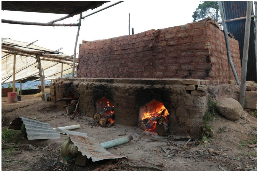
En hornos de leña se queman los ladrillos para que estén listos. XCA
