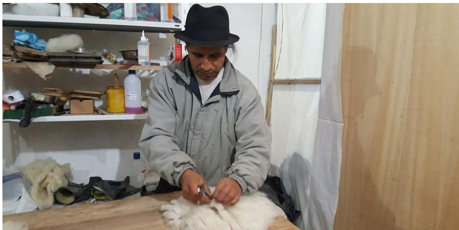
Una vez laminado el material, una lona es cubierta por la lana para dar forma de campana. Se rellena con la mayor cantidad de materia prima posible con el fin de evitar vacíos o aberturas. Esto se va moldeando “al tacto y al ojo”, reveló Sarango.
