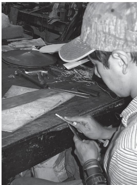
Para trazar los moldes sobre la suela, los talabarteros utilizan la lezna o la punta del compás, instrumentos que en estos momentos del proceso productivo los usan a manera de lápiz; y, mientras con la mano izquierda sostienen el cartón, con la derecha van trazando los contornos de los moldes para de inmediato proceder a su corte.
