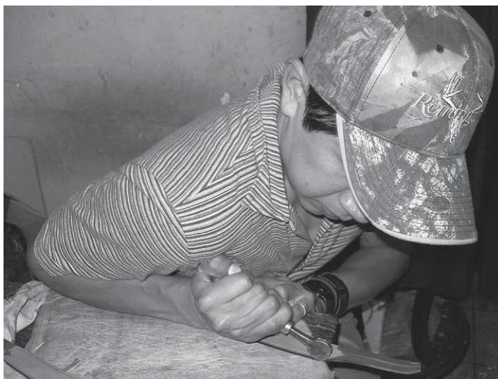
Una vez cortadas las piezas con un trozo de vidrio van raspando los filos de la suela para pulirla y evitar los desprendimientos de piel que pueden lastimar, además, con el bruñidor la van alisando y preparando para trazar los dibujos y diseños que irán repujados.
